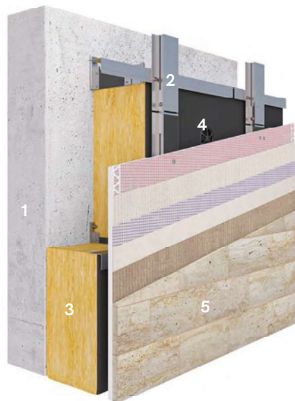
Aufbau einer vorgehängten hinterlüfteten Fassade
